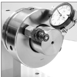
5 | Posicione o relógio comparador na porca hidráulica
